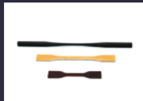
哑铃形试样： 碳纤维、浇注体、植物纤维
