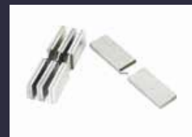
V形剪切GLARE试样
