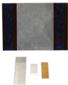
120°C中温粘贴成型加强片拉伸试样: 矩加强片与角度加强片 (铝、钛、复材)
